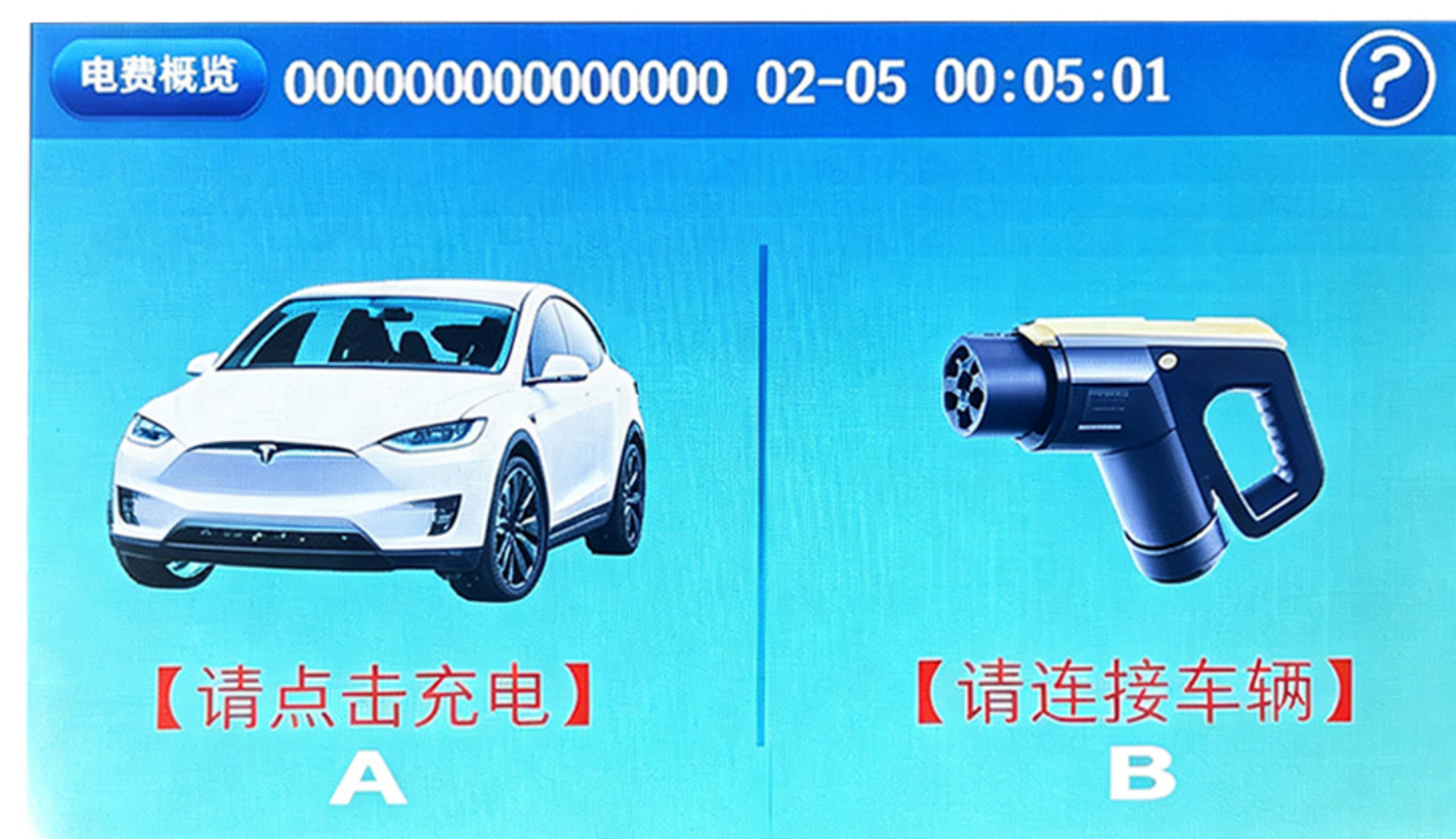
02 汽车桩双枪主板使用界面 左侧为枪线已连接，右侧为未连接枪线
