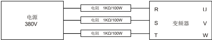
图 9-1 380V 驱动装置充电电路示例
